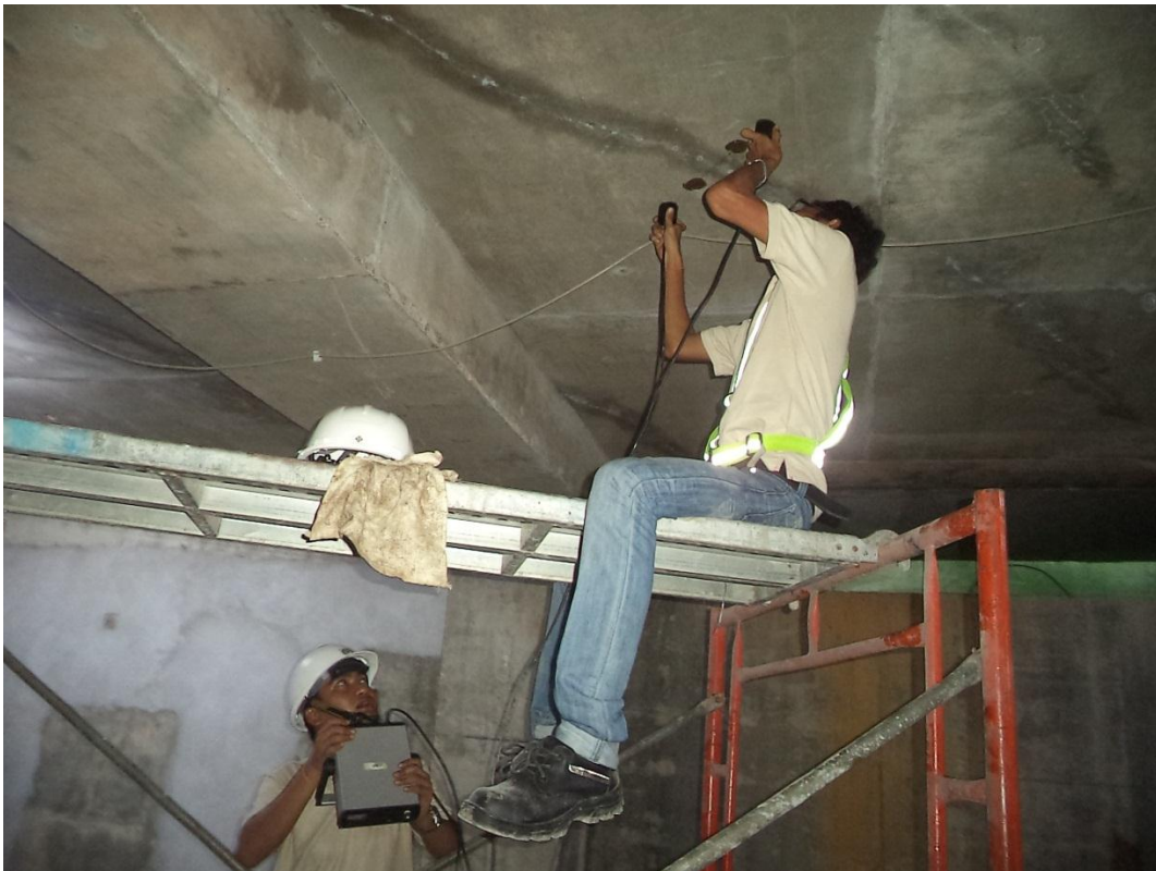
Ultrasonic Pulse Velocity (UPV) Test ပြုလုပ်ခြင်း
